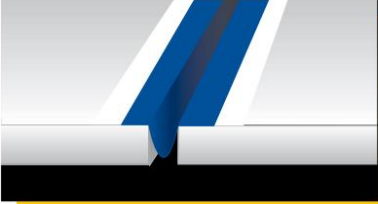
Bir genişleme derzine omega ( \Omega ) şeklinde yerleştirilmiş MAPEBAND
